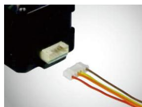
17HS 公端:JST S6B-PH-K 母端:JST PHR-6
